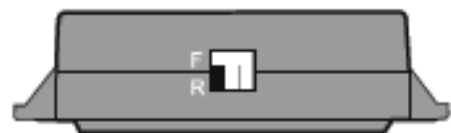
Jumper Position "R" System für den Heckbereich eingestellt
