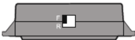
Jumper Position: "F" System ist im Frontbereich eingestellt
